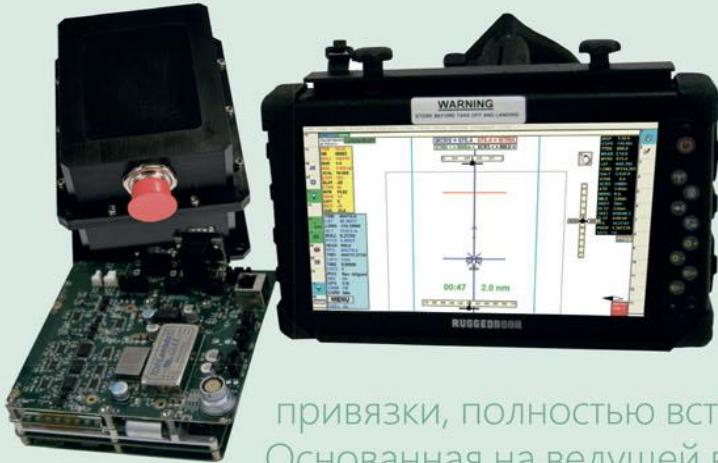
UltraNav - это система управления полетом и прямой географической привязки, полностью встроенная в сенсор камеры UltraCam. Основанная на ведущей в отрасли технологии POSTrack от Applanix, система Applanix предназначена для обеспечения максимальной эффективности аэрофотосъемки. Это решение доступно в четырех различных конфигурациях: 010, 310, 410 и 510. Все IMU, используемые для UltraNav являются "ITAR-free" для повышения эксплуатационной гибкости.
